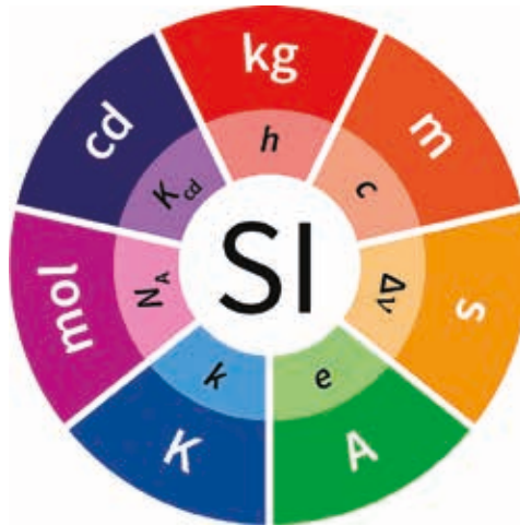
Abb. 4: Die 7 Basiseinheiten unseres internationalen Einheitensystems mit den etablierten Basiseinheiten Kilogramm, Meter, Sekunde, Ampere, Kelvin, Mol und Candela (äußerer Ring) sowie den zugeordneten Naturkonstanten (innerer Ring). Quelle: BIPM
